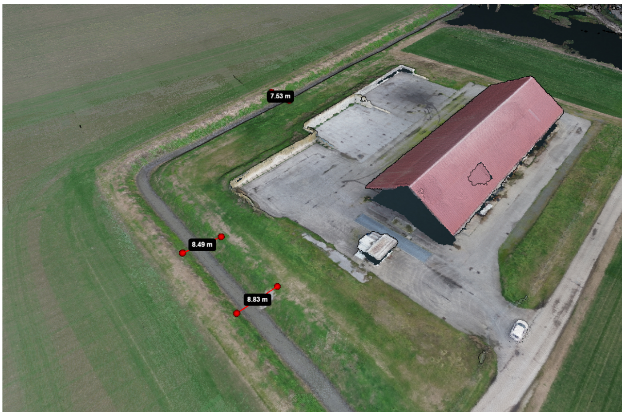
Figura 1 elaborazione del rilievo Lidar su lato ingresso
